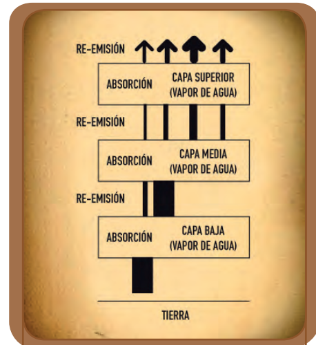
Figura 27. Diagrama esquemático de la radiación en la imagen de vapor de agua
