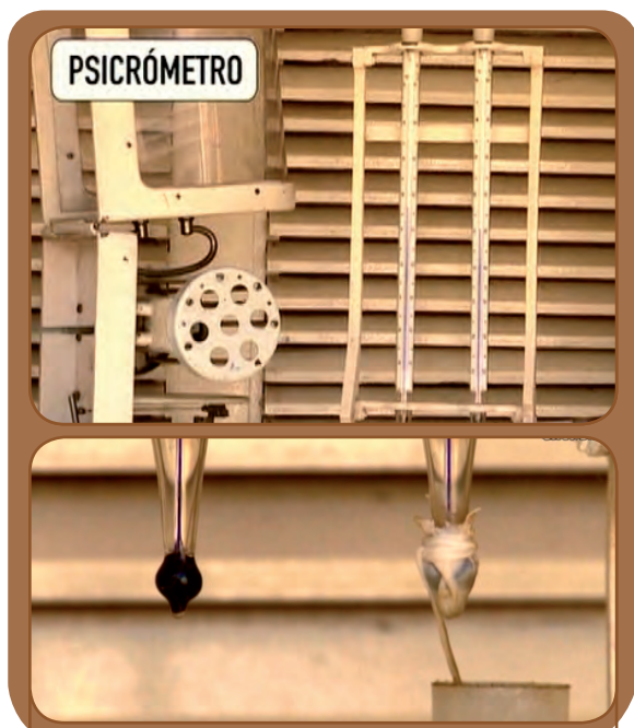
Figura 13. Psicrómetro de abrigo detrás del termómetro de máxima y mínima: pareja de termómetros seco, izquierda, y húmedo, derecha. El bulbo del termómetro húmedo está envuelto en una muselina húmeda conectada a un depósito con agua destilada
