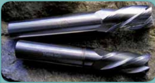
Fresas cilíndricas de 4 cortes
