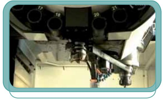
A fines del siglo pasado, ya se manejaban sistemas denominados **modulares** que permiten efectuar el cambio de una herramienta por otra similar en un mismo anclaje de la torre del torno o fresadora, con un sistema de sujeción práctico y simple, permitiendo una mayor versatilidad y reducción de los tiempos muertos en la máquina herramienta que cuenta con dicho dispositivo de sujeción.
