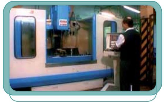
A fines de la década de los 70 y principios de los 80, se empezaron a diseñar máquinas que pudieran ejecutar con la misma calidad varias operaciones, tratando de que estas pudieran realizar aproximadamente el 90% del mecanizado en una sola máquina.
