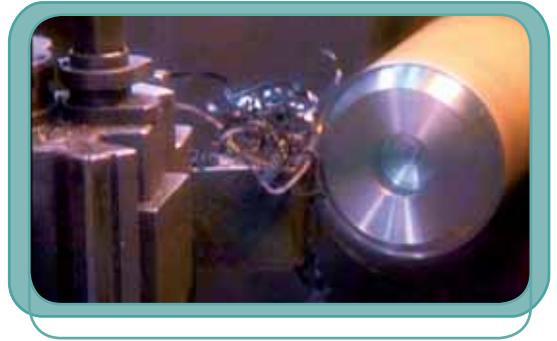
El caso de máquinas con rotación de la pieza, sería un **torno** o **tronzadora**, donde la pieza está sujeta a un plato giratorio que gira a distintas velocidades, mientras la herramienta se encuentra en una torreta fija y solo se mueve en forma transversal o paralela al eje de la pieza.
