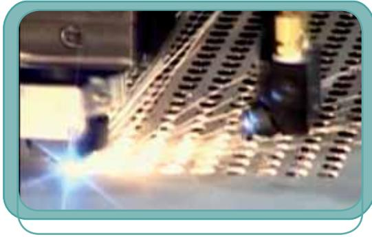
vedosos exponentes en la fabricación avanzada es el proceso de **mecanizado por láser** que permite el mecanizado de formas complejas y de pequeño tamaño en todo tipo de materiales. Incluso en el caso de los problemas concretos que suelen presentar piezas de geometría compleja y de reducido tamaño, el uso de un proceso mixto **fresado/láser** abre posibilidades completamente nuevas en el mecanizado.
