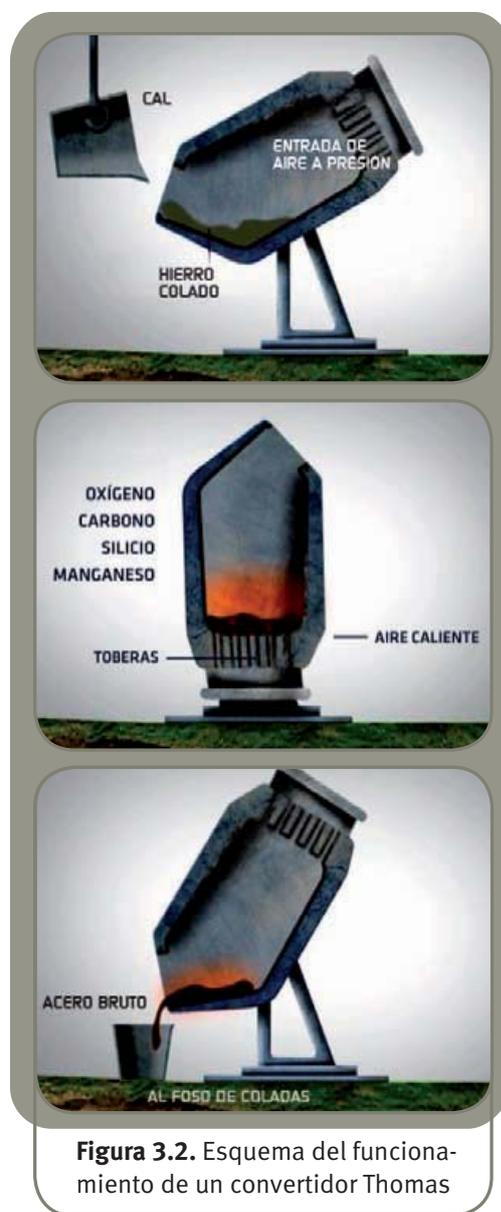
**Figura 3.2.** Esquema del funcionamiento de un convertidor Thomas
