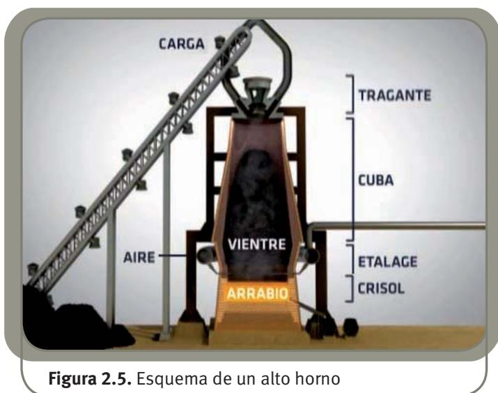
Figura 2.5. Esquema de un alto horno
