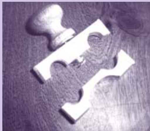
Cortocircuitador con rebaje para tubo fluorescente y resorte
