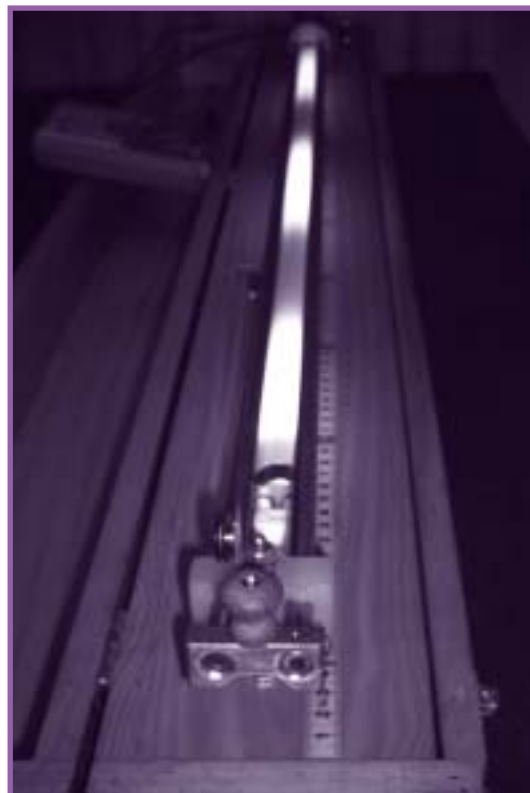
Línea de Lecher terminada en cortocircuito
