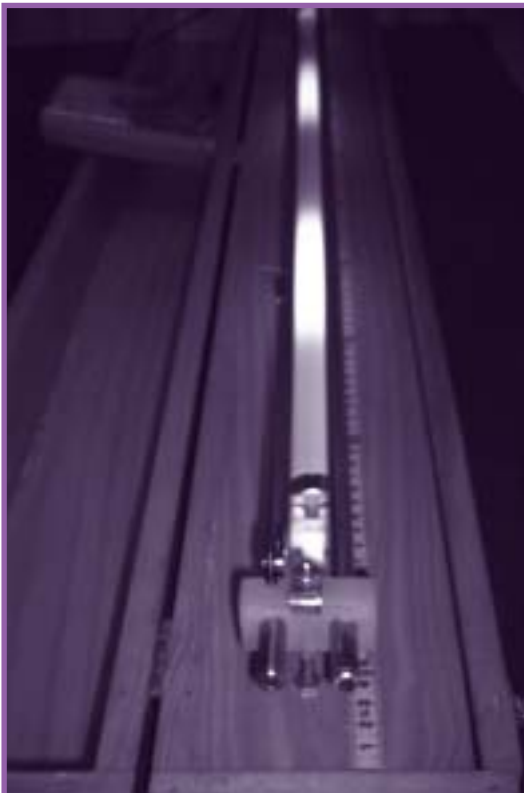
Línea de Lecher terminada en circuito abierto
