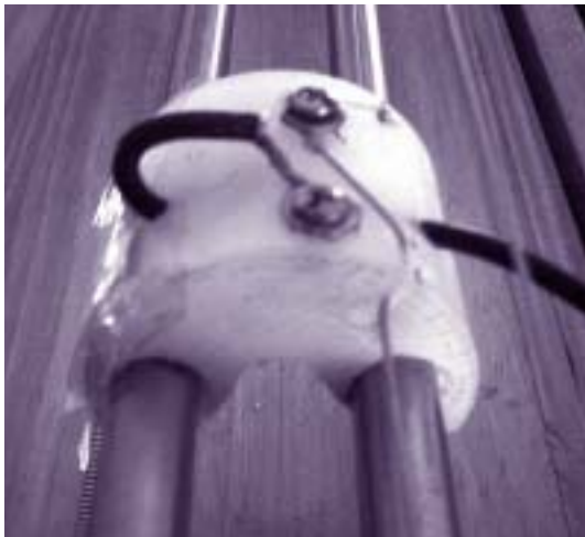
Ubicación del lazo captor en relación con el campo magnético
