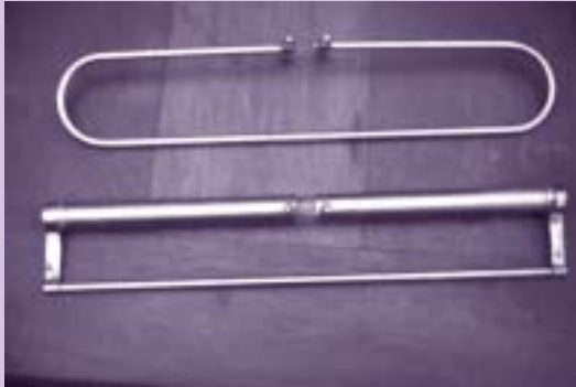
Dipolos plegados: de 300 ohm y de 200 ohm
