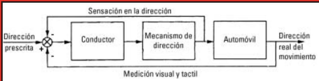
Diagrama del sistema de control en la conducción de un vehículo automotor
