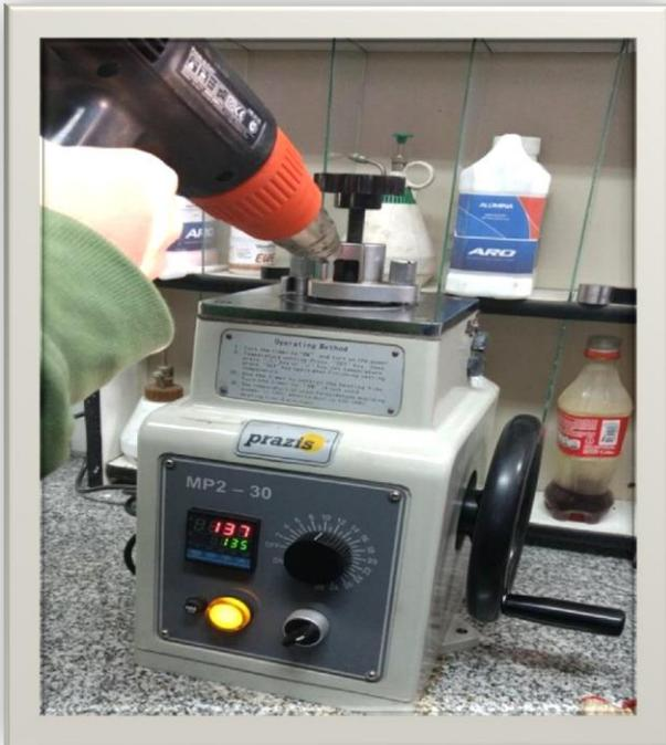
**Paso 2:** Se trasladó cada muestra a la incluidora metalográfica, con previa colocación del tapón superior en cada caso (Ver imágenes) para terminar las probetas por un proceso a presión y temperaturas constantes. Vale aclarar que todas las probetas se realizaron bajo las mismas condiciones. Se dejó cada muestra por 10 minutos a una temperatura de 140 °C para simular las condiciones que se dan con una matriz e inyectora apropiadas.
