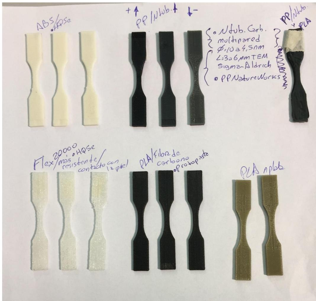
En la imagen se pueden observar las probetas de PP con distintos porcentajes de NTC realizadas por la FAN en la impresora chimak 3D.
