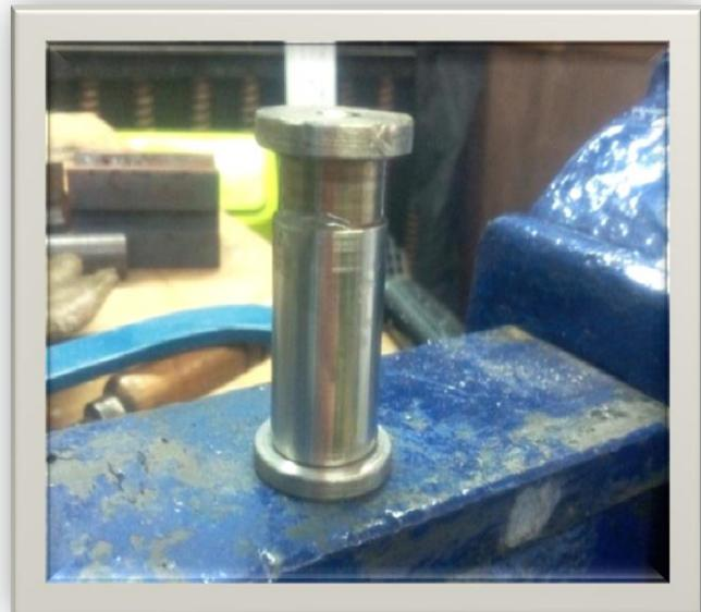
**Paso 3:** Finalizado el tiempo programado, se retiró el molde, dejándolo enfriar a temperatura ambiente hasta 35°C, y luego se aceleró el enfriamiento con aire comprimido y agua.
