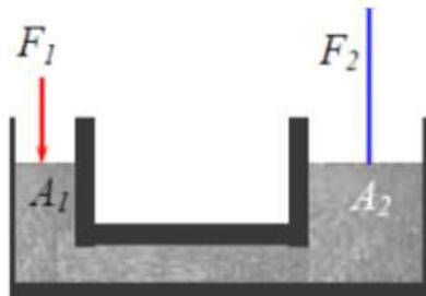
Si se aplica una fuerza  $F_1$  sobre un área  $A_1$  como se ve en la figura, la misma presión se transmitirá con una fuerza  $F_2$  sobre un área  $A_2$  y por la definición de presión:  $P = \frac{F_1}{A_1} = \frac{F_2}{A_2}$
