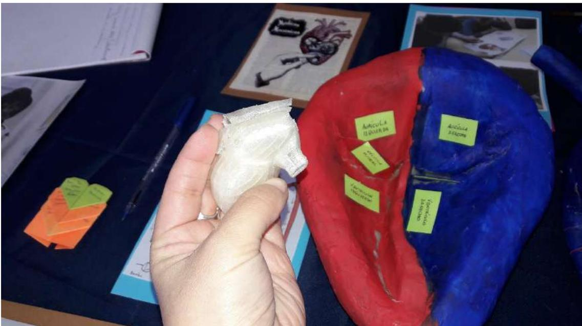
**INCONVENIENTE 4** → Una vez obtenida la prueba de impresión, en líneas generales había resultado fallida. El exterior del corazón se rompía por la falta de espesor en las paredes del diseño digital. Por eso se descartó realizar una impresión de las mitades ya que se presuponía de que iba a suceder lo mismo.
