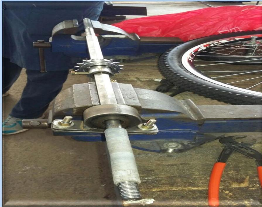
**-Se realizó las tasas exteriores para rulemán y se comprobó la tolerancia para que gire la rueda**
