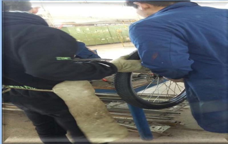
**-Se montó el eje a la estructura y se realizó la soldadura en dicho eje. Este es desmontable.**
