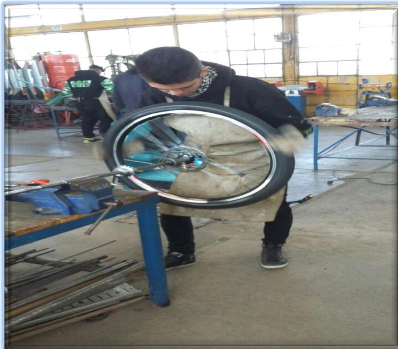
**-En el eje se realizó una rosca y tope para ruedas de bicicletas Mountan Bike, rodado 26 con freno de disco.**
