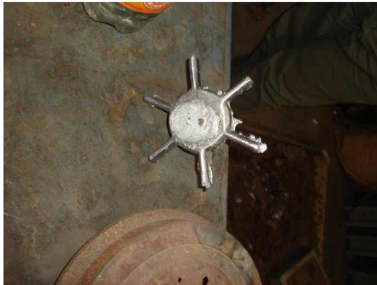
Fig. 4 Pieza Terminada de molde de arena
