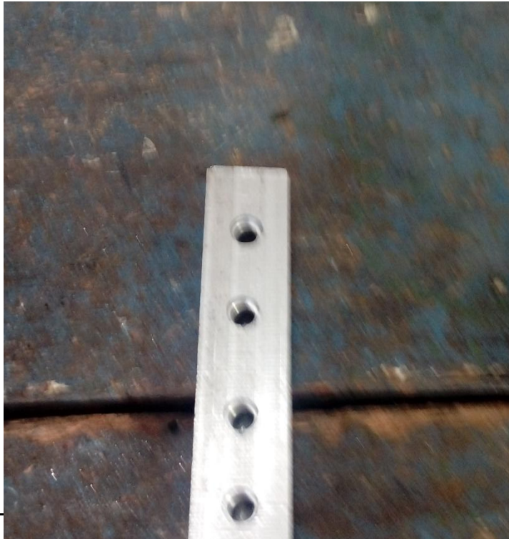
Fig. 23 Tocho perforado para el trabajo de limpia inyectores
