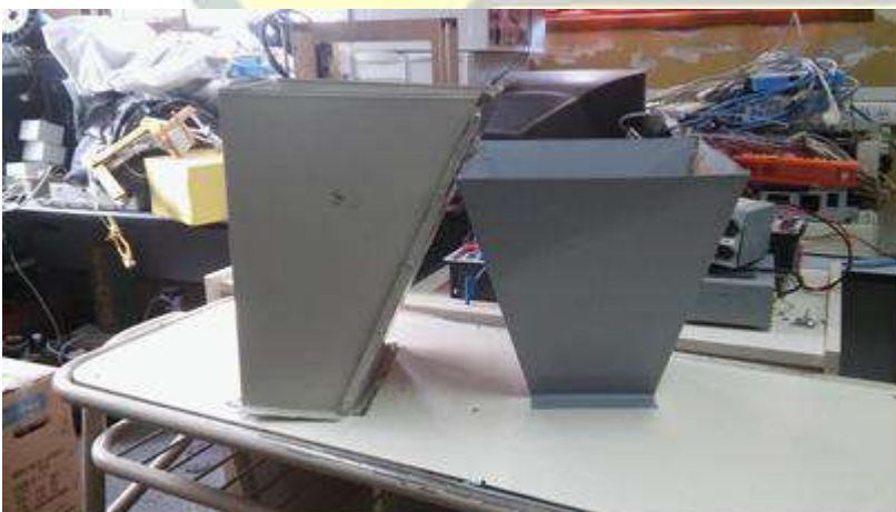
Armado de tolvas
