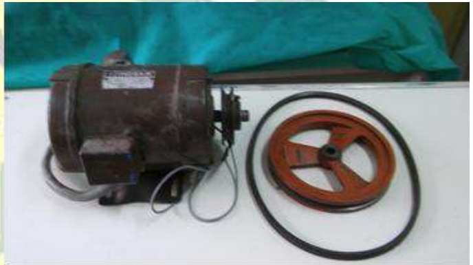
Retirando el Motor del compresor
