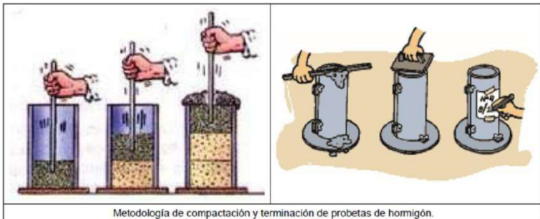
Metodología de compactación y terminación de probetas de hormigón.
