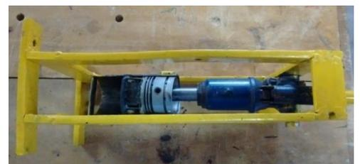
**Figura 02.** Dispositivo diseñado para la extracción del aceite de Sacha Inchi luego de la trilla y el descascarado manual de las semillas.
