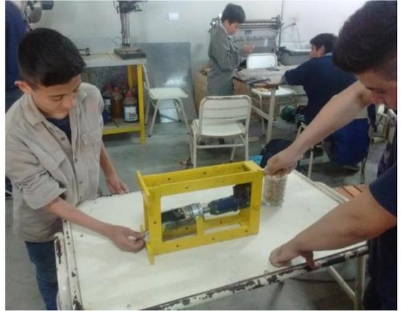
**Figura 05.** Prensado en frío de la semilla descascarada de Sacha Inchi para obtención del aceite.
