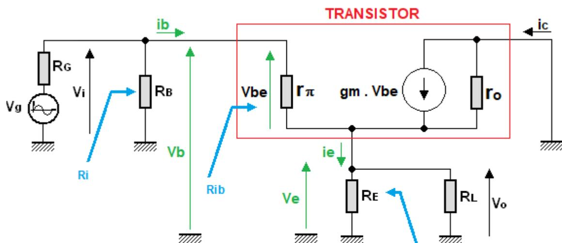
$$R_{ib} = \frac{V_b}{i_b} \quad \text{Resistencia de entrada vista desde la base}$$
