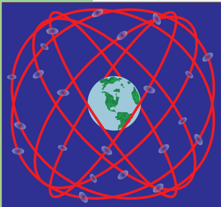
Figura 10.9. Esquema de las órbitas de los satélites que conforman el sistema GPS.
