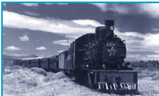
La trochita (Esquel, Chubut), locomotora a vapor Henschel & Sohn de origen alemán, fabricada en el año 1922; posee una caldera tubular y funciona a fuel-oil. www.latrochita.org.ar
