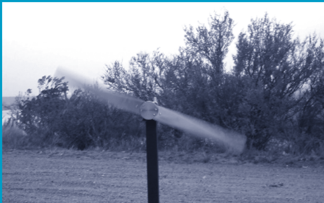
Confirmando los buenos vientos sureños, probamos nuestro generador eólico. Aquí se lo ve girando, gracias a ráfagas de viento de 74 km/h (unos 20 m/s) en las afueras de la ciudad de Viedma
