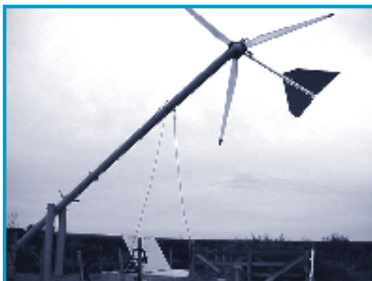
Reinstalación, tras realizarle el servicio técnico, de una de las primeras turbinas fabricadas por INVAP, la IVS 4500, en su vieja versión tripala. www.invap.net
