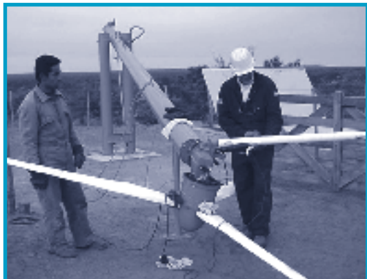
Mantenimiento anual del generador eólico IVS 4500, instalado en medio de la estepa neuquina -en este caso, aprovechando la torre abatible-. www.invap.net
