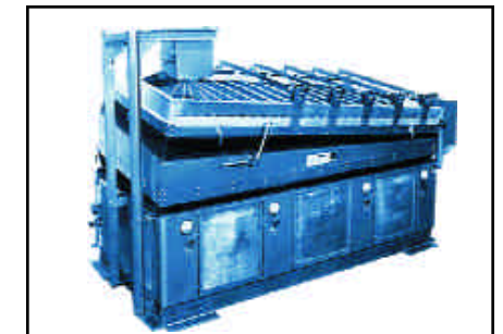
Figura 9.3. Sistema de separación por gravedad.
