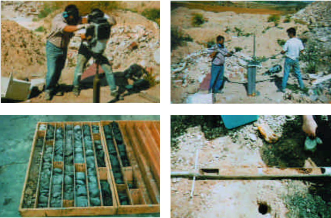
Figura 16.1.: a) Perforación del suelo con motor percutor; b)Extracción de la barrena mediante palancas; c) Testigo de un punto de muestreo; d) Detalle de la muestra extraída con la barrena.
