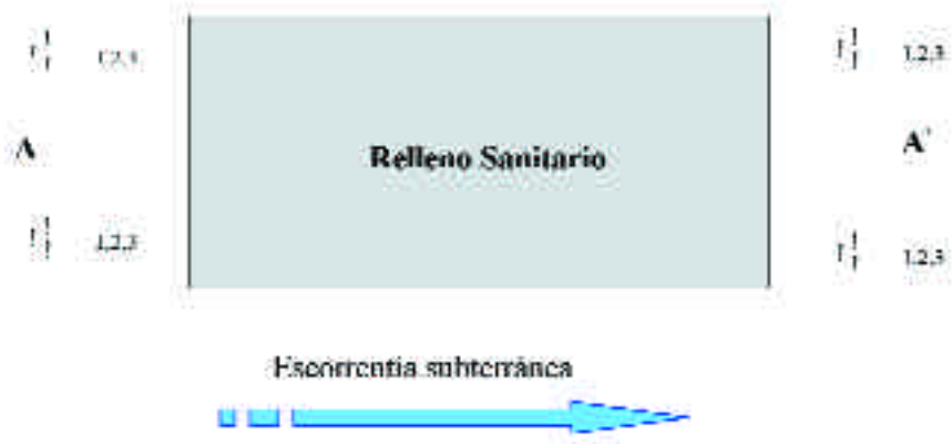
Figura 17.1. Esquema de flujo de aguas subterráneas y puntos de monitoreo: Plano. Fuente: Elaboración propia, 2002
