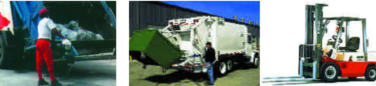
Figura 8.1.Métodos manuales para la recolección de residuos sólidos domésticos, a) Levantamiento directo; b) Deslizamiento de contenedores; y c) uso de montacargas.
