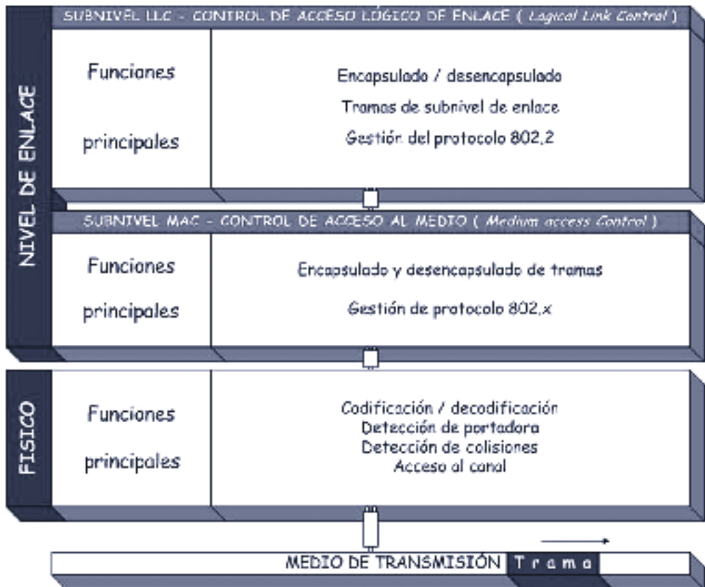
Funciones principales del nivel físico y del de enlace Norma 802.3
