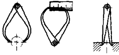
Medición indirecta con el compás
