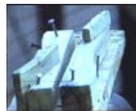
Matriz de corte en ángulo en tablas de álamo, para el bastidor.
