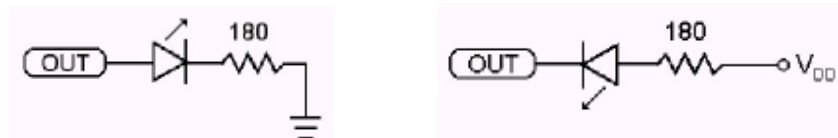
Dos posibles formas de conectar un led
