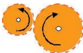
Acoplamiento directo de engranajes = inversión de rotación
