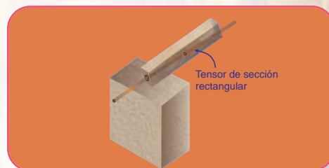
Figura 5.63. Tensor colocado de canto
