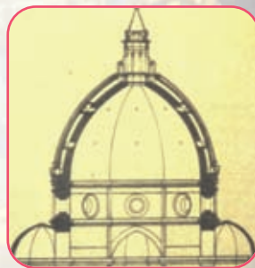
Imagen 5.32. Esquema del diseño de la Cúpula de Santa María del Fiore. Firenze - Italia
