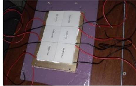
Las celdas fueron montadas entre medio de dos disipadores de aluminio anodizado ZD34X10C de 160mm x 100mm de superficie.
