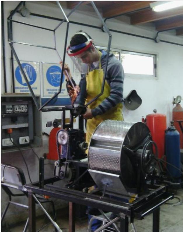
A fin de realizar diversas experiencias con los tamaños de grano posibles, se propone realizar grillas intercambiables con perforaciones de distintas secciones, que puedan instalarse en la en las paredes radiales de la criba.
