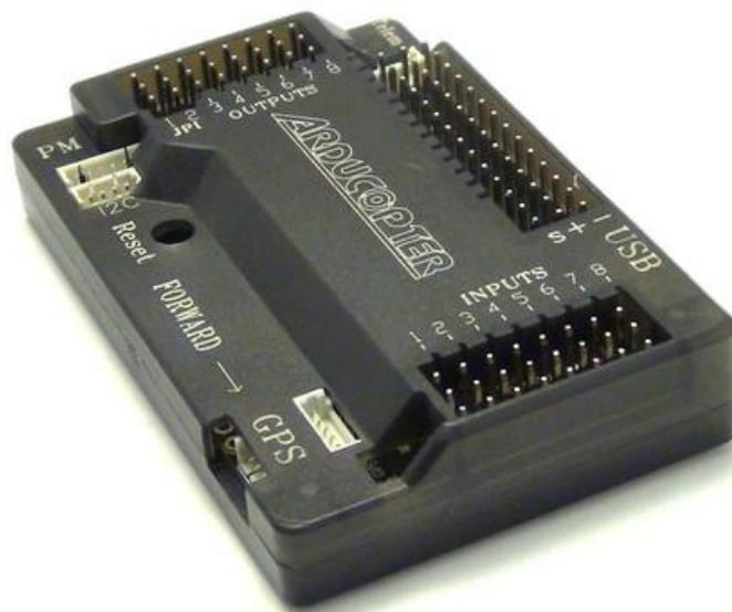
Optamos por esta mejora ya que es una placa, más pequeña y que tiene incorporadas varios elementos integrados que en Arduino teníamos que conectar aparte, además que con esta placa se nos ha facilitado la implementación de GPS además del uso autónomo del dron.
