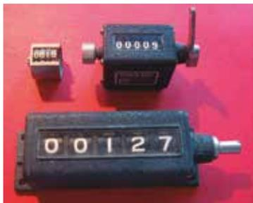
Mucho antes de que la electrónica se volviera común, los dispositivos mecánicos se usaban para contar eventos. Estos se conocen como dispositivos de conteo o contadores mecánicos. Por lo general, consisten en una serie de discos montados en un eje, con los dígitos del cero al nueve marcados en su borde. El disco más a la derecha se mueve un incremento
