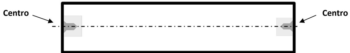
c) La tercera operación se realiza en un torno CNC, donde se tornean los distintos escalones de los distintos ejes.
